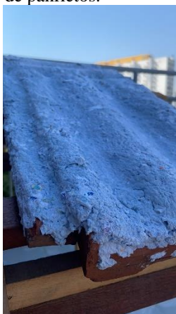
Figura 1. Telha ecológica sintetizada a partir de panfletos.
