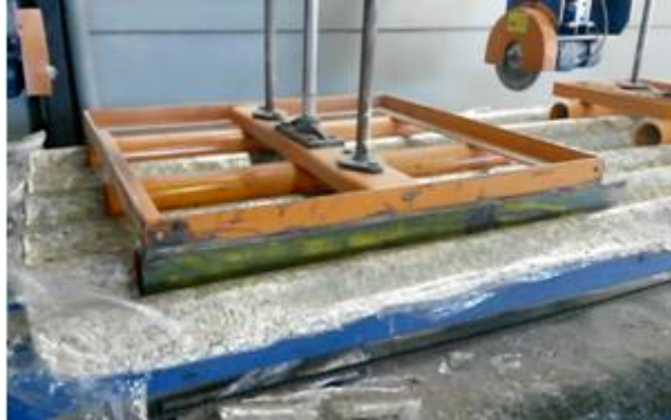
Figura 3. Máquina responsável por realizar as aparas das arestas das telhas.
