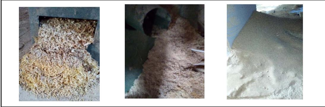
Figura 7: Maravalha, Serragem e Pó de madeira
