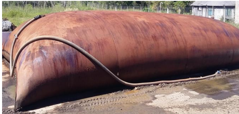
Figura2 – Bag desidratador aplicado no tratamento do lodo da ETA de São Gabriel – RS.
