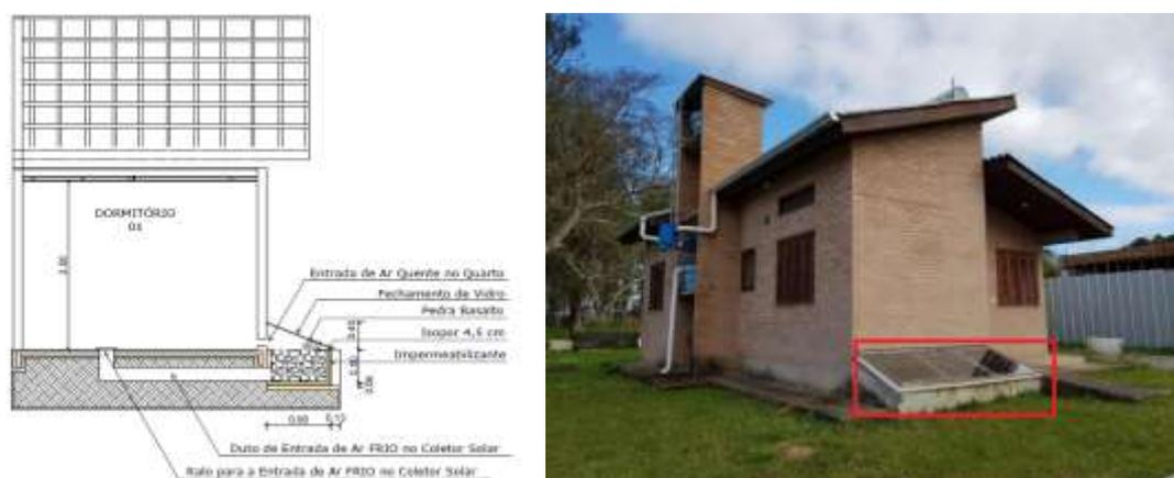
Figura 03: Sistema Solar Passivo de Aquecimento de ar através do ganho isolado de calor na Casa Popular Eficiente da UFSM.
