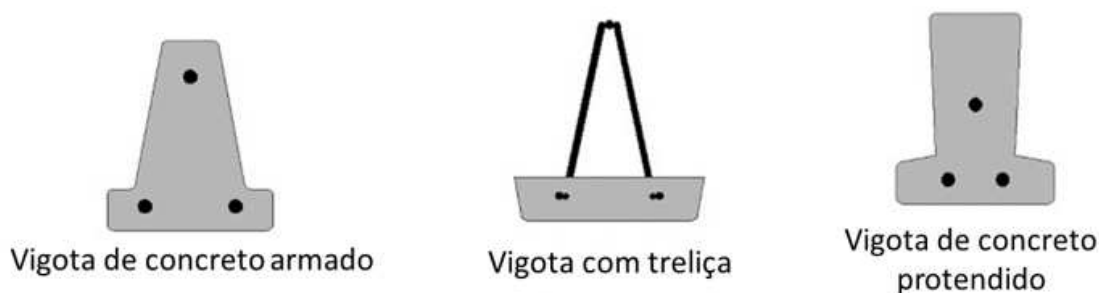
Figura 1 – Tipologias de vigotas de lajes pré-fabricadas.
