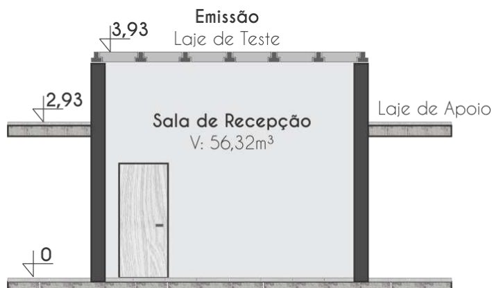
Figura 3 - Corte Longitudinal AA' do local de ensaio
