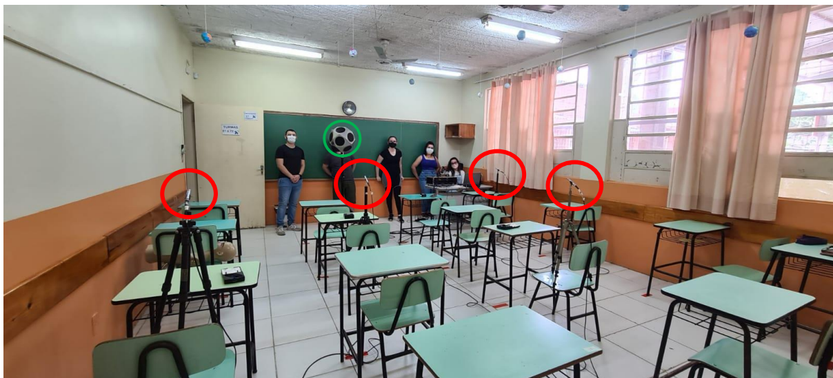
Figura 4 – Posicionamento da fonte sonora e de alguns pontos de medição na sala de aula
