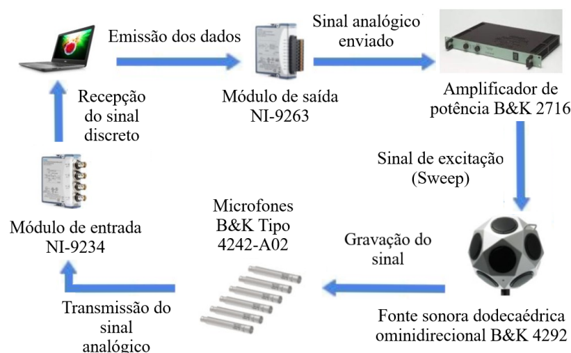
Figura 5 - Diagrama do fluxo de sinais para obtenção da resposta impulsiva da sala de aula
